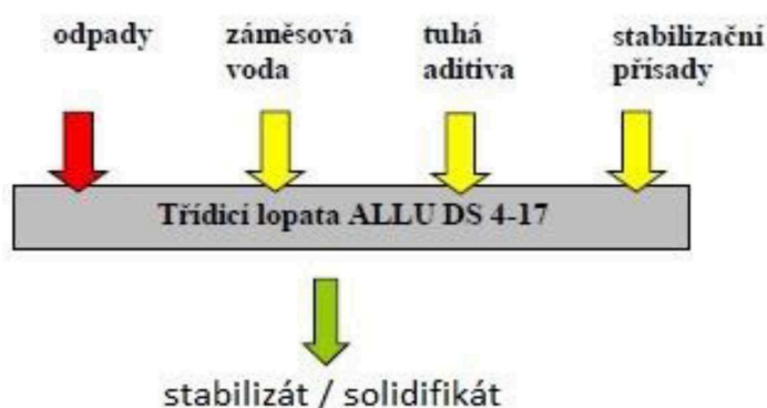
Obrázek č. 4: Technologické schéma míchací lopaty
