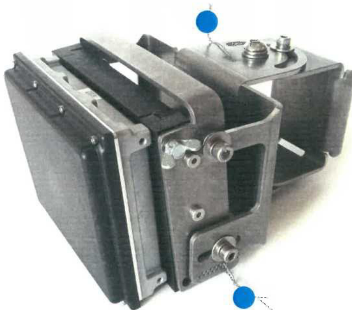
Obr. 10 Radarový senzor XS-SMR s dělitelným držákem (modře jsou označena místa pro zajišťovací značky výrobce)
