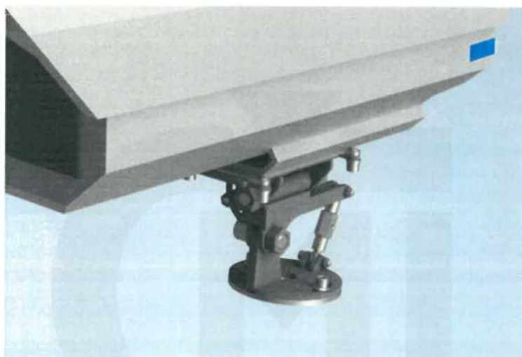
Obr. 7 Držák kamery mechanicky zabráňující záměně kamer (modře je označeno místo pro zajišťovací značku výrobce)
